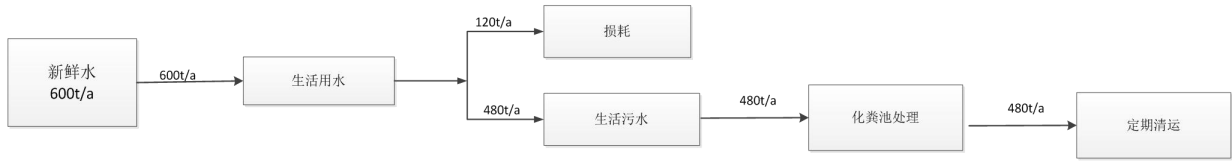
图3-1 项目一期工程水平衡图 (t/a)
