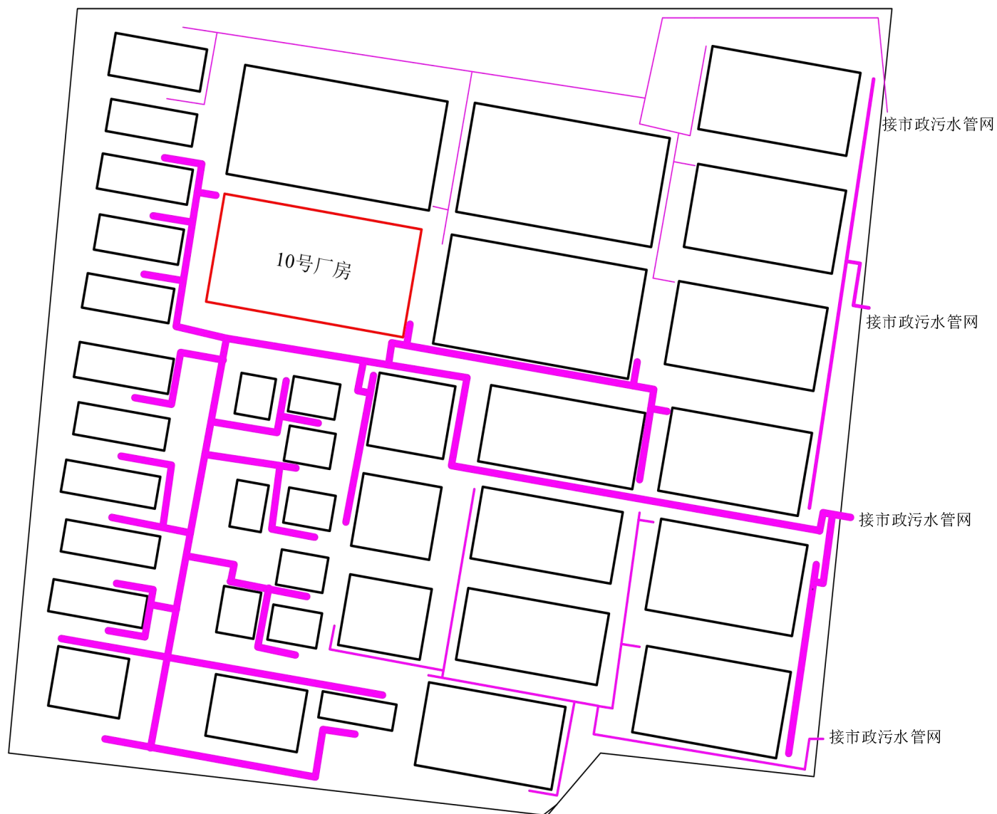
附图 6 工投科技产业园污水管网图
